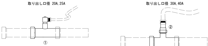
仮設取出短管設置工 50A～250A
